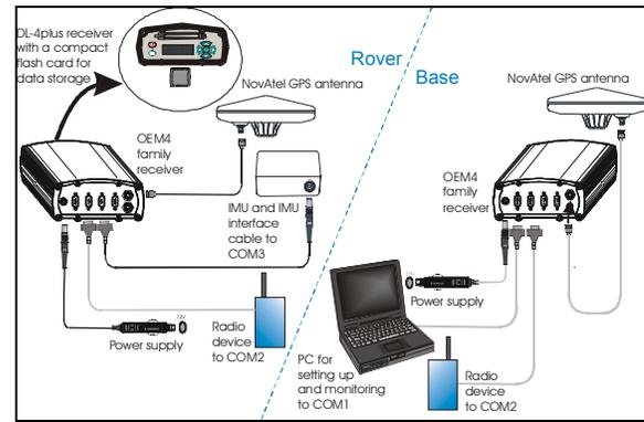
Fig. 3. SPAN Setup
